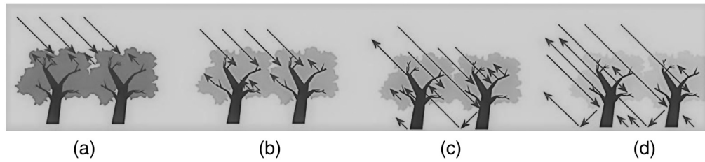
Fig. 3 SAR band: (a) X-band (3 cm); (b) C-band (6 cm); (c) L-band (24 cm); (d) P-band (65 cm). 22
